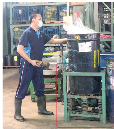
▲ 中高齡員工操作震動整平機，使桶內鐵鍊平整均勻
