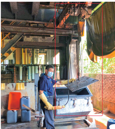
▲ 中高齡員工操作天車，處理電鍍前置作業，使金屬鍍件表面光潔，增強表面活性
