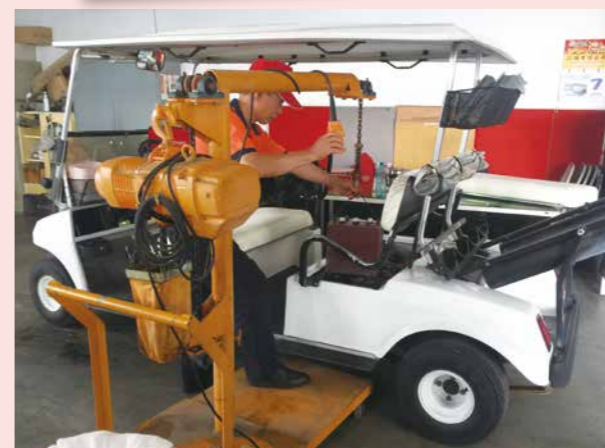
設計訂做專用吊運推車承載較重的電動車馬達，減輕中高齡員工腰部負擔。
