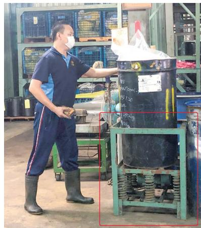
▲ 中高齡員工操作震動整平機，使桶內鐵鍊平整均勻
